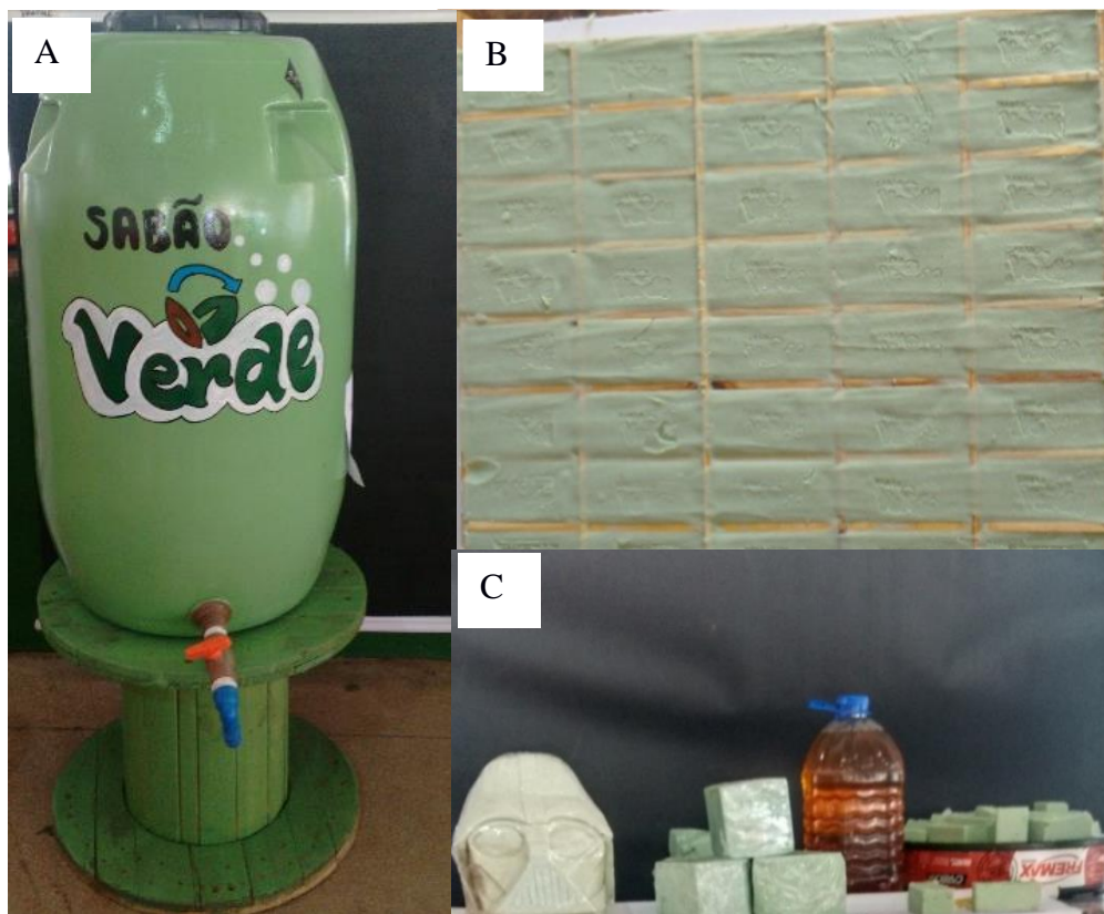
Figura 14 - Acondicionamento do óleo residual (A), finalização da produção de barras de sabão em formas (B) e produtos gerados: escultura e barras de sabão (C)
