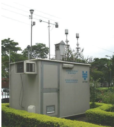
Figura 6 - Estação automática de monitoramento da qualidade do ar de Pinheiros, localizada na sede da CETESB, em São Paulo
