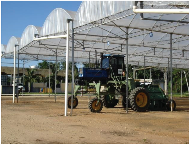
Figura 6 - Trator enleirador ou composteira utilizado no revolvimento das leiras.
