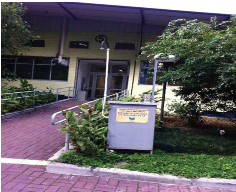
Figura 5 - Estação manual de monitoramento da qualidade do ar de Pinheiros, localizada na sede da CETESB, em São Paulo
