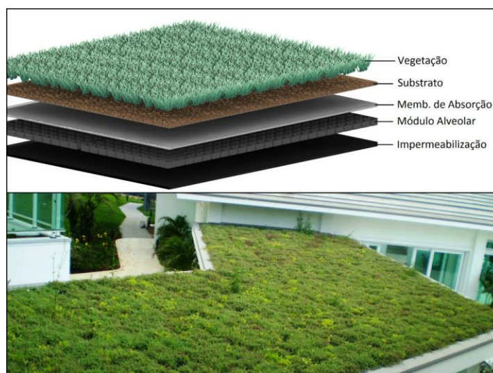
Figura 1 : Estrutura de um Telhado Verde
