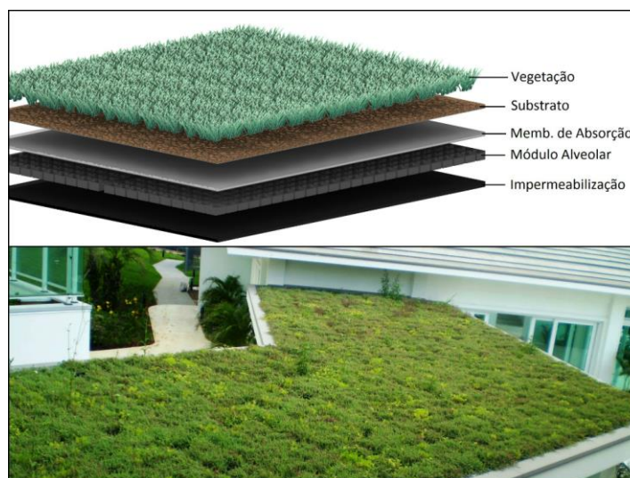
Figura 1 : Estrutura de um Telhado Verde
